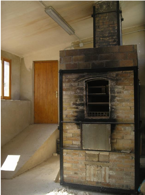
Figura 2. Horno de leña para gres, de bajo consumo.
