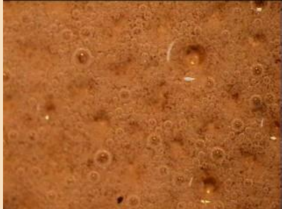
Figura 2. Burbujas en un esmalte transparente. Fotografía: Enrique Algora.
