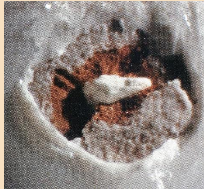
Figura 2. Caliche en una cerámica esmaltada. Fotografía: AMORÓS ALBARO, J.L. et al. "Defectos de fabricación de pavimentos y revestimientos cerámicos", Pg. 50. AICE-ITCE. Conselleria d'Industria de la Generalitat Valenciana. València.
