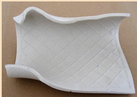
Figura 2. Baldosa industrial deformada por efecto del empuje de otras baldosas en un atasco en el tapete del horno monoestrato. Fotografía: Ana Monferrer.
