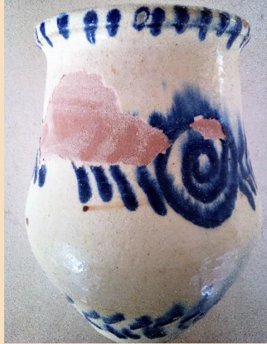
Figura 1. Desconchado por falta de adherencia entre esmalte y soporte. Fotografía: Rafa Galindo.
