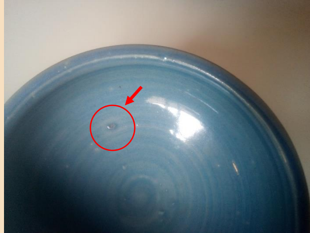
Figura 1. Infundido de refractario desprendido y pegado al esmalte. Fotografía: Rafa Galindo. .
