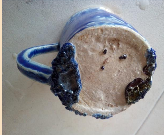
Figura 1. Ecurrido de un esmalte con muy baja viscosidad en fundido. Fotografía: Rafa Galindo.
