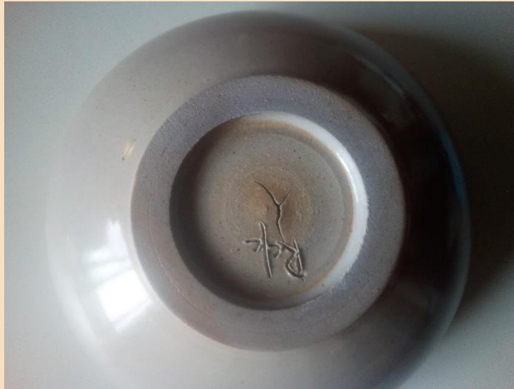
Figura 1. Grieta en la base de un bol torneado. Fotografía: Rafa Galindo.
