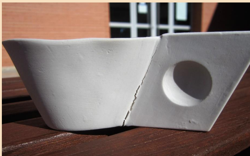
Figura 2. Grietas debidas a una incorrecta unión de dos partes de la pieza. Fotografía: M a Dolores Notari.
