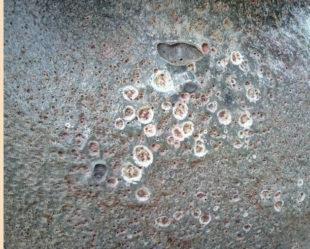
Figura 1. Esmalte hervido por exceso de temperatura. Fotografía: Rafa Galindo.
