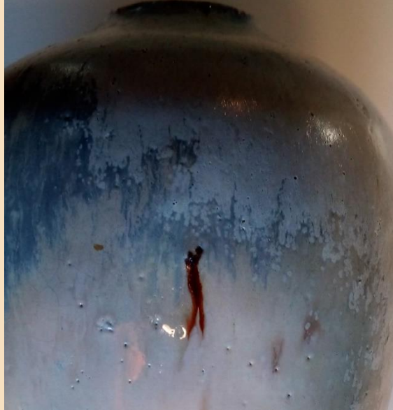
Figura 1 Defecto de punto coloreado por contaminación de minerales de hierro del soporte, acompañada de pinchados. Fotografía: Rafa Galindo.
