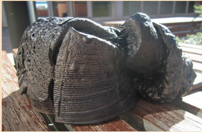
Figura 1. Pieza cerámica pasada de cocción. Fotografía: Mª Dolores Notari.
