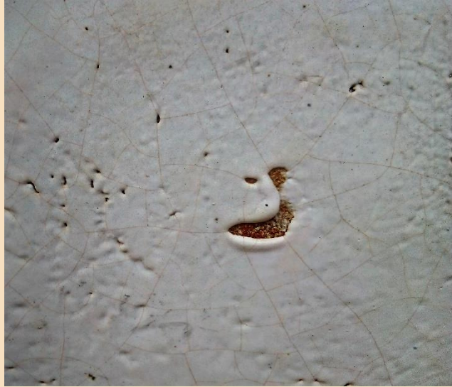
Figura 4. Retirado del esmalte a causa de suciedad en el soporte. Fotografía: Rafa Galindo.
