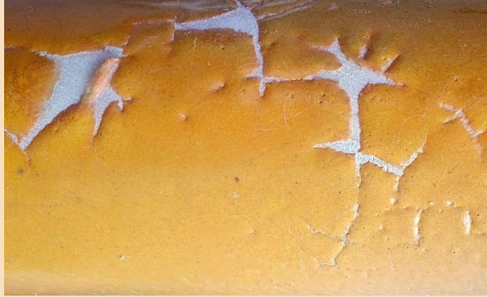
Figura 1. Retirado de un esmalte opaco coloreado por una excesiva contracción en secado de la capa de esmalte. Fotografía: Rafa Galindo.
