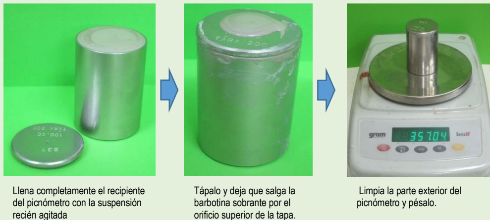
Figura 1. Procedimiento de medida de la densidad mediante picnómetro de líquidos.
