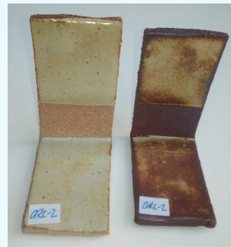
Figura 2. Prueba de esmalte amarillo de hierro. Referencia: (6).
