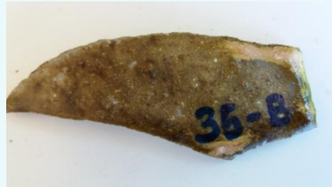
Figura 3. Prueba de esmalte amarillo de hierro. Autor: Rafa Galindo.
