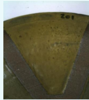
Figura 5. Prueba de esmalte amarillo de hierro - bario. Autor: Rafa Galindo.
