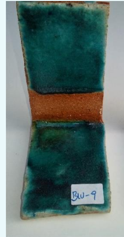
Figura 3. Prueba de esmalte azul de Cu-Ba. Referencia (1)
