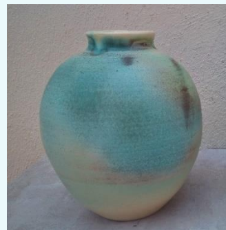
Figura 1. Jarra de gres con esmalte azul de cobre-bario (altura 27 cm). Autor: Rafa Galindo.
