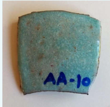
Figura 5. Prueba de esmalte azul turquesa de cobre - alcalinos. Autor: Rafa Galindo.
