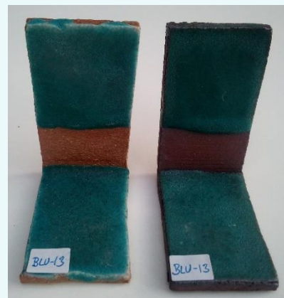
Figura 4. Prueba de esmalte azul de cobre - estroncio. Referencia: (2).
