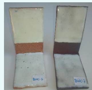
Figura 6. Prueba de esmalte blanco brillante, sobre pasta blanca y roja. Referencia: (9).
