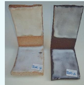
Figura 8. Prueba de esmalte blanco brillante, sobre pasta blanca y roja. Referencia: (9).
