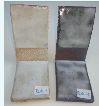
Figura 5. Prueba de esmalte blanco brillante, sobre pasta blanca y roja. Referencia: (9).
