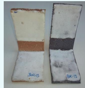
Figura 7. Prueba de esmalte blanco brillante, sobre pasta blanca y roja. Referencia: (9).
