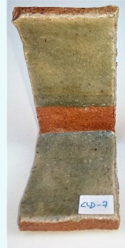
Figura 2. Prueba de esmalte celadón verde. Referencia (4).
