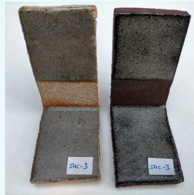
Figura 4. Prueba de esmalte shino carbon trap. Autor: Rafa Galindo.
