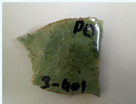
Figura 3. Prueba de esmalte verde Oribe sobre engobe blanco. Autor: Rafa Galindo.
