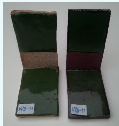
Figura 3. Prueba de esmalte coloreado con óxido de cromo (III), aplicada sobre soportes de pasta blanca y pasta roja. Referencia: J. Britt (8)
