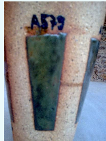
Figura 4. Prueba de esmalte verde de níquel. Referencia (5).
