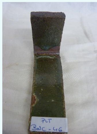
Figura 2. Prueba de esmalte verde de níquel. Aplicado sobre engobe blanco. Autor: Rafa Galindo.
