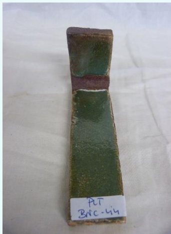
Figura 1. Prueba de esmalte verde de níquel. Aplicado sobre engobe blanco. Autor: Rafa Galindo.
