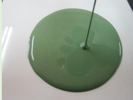
Figura 3. Tinta cerámica para aplicación serigráfica. Fotografía: Ana Monferrer
