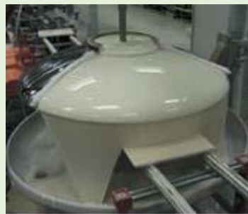
Figura 2. Esmalte en suspensión, aplicado en lengua de campana.
