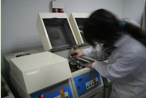
Figura 1. Preparación de un esmalte por molienda en molinos planetarios. Fotografía: Miquel Cantavella.
