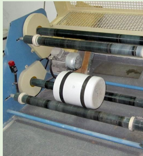
Figura 4. Molino de jarra y bastidor (con la rejilla de seguridad levantada para la fotografía). Fotografía: Ana Monferrer.
