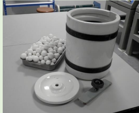
Figura 3. Jarra de porcelana y carga de bolas. Fotografía: Ana Monferrer.
