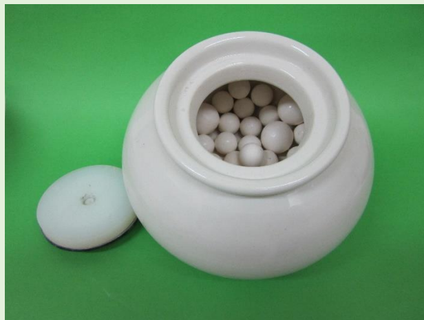
Figura 7. Jarra y carga de molas para molino planetario. Fotografía: Ana Monferrer.
