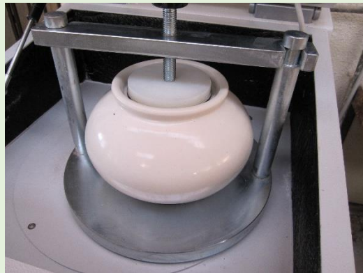
Figura 6. Disposición de la jarra en un molino planetario. Fotografía: Ana Monferrer.
