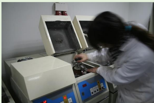
Figura 1. Preparación de un esmalte por molienda en molinos planetarios.
