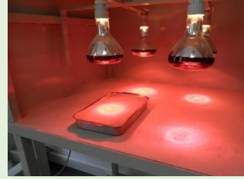
Figura 4. Secado mediante lámparas infrarrojas. Fotografía: Rafa Galindo.
