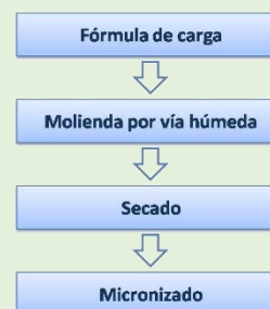
Figura 1. Preparación de esmaltes en polvo por secado de barbotinas.
