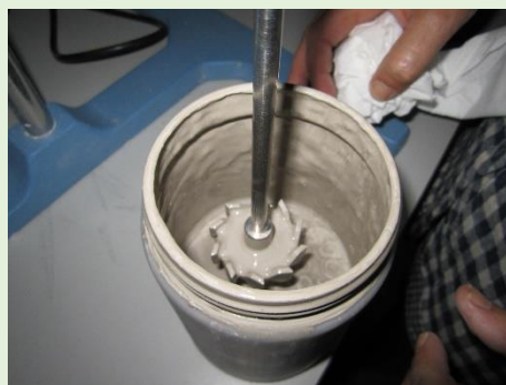
Figura 2. Preparación de un engobe por desleído.
