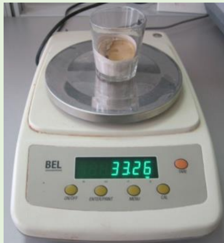
Figura 1. Medida del contenido en sólidos de una barbotina. Fotografía: Ana Monferrer.
