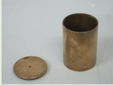
Figura 2. Picnómetro de líquidos (recipiente y tapa perforada).
