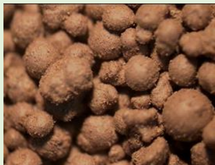
Figura 1. Polvo atomizado de pasta roja para prensado de baldosas cerámicas. Fotografía: Rafa Galindo.
