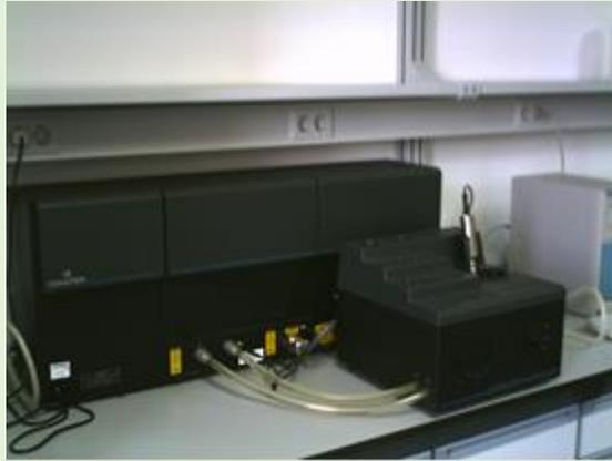
Figura 1. Equipo de difracción láser para la medida de distribuciones granulométricas.
