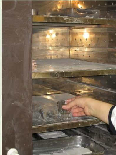
Figura 4. Se introduce en la estufa para su secado a peso constante.
