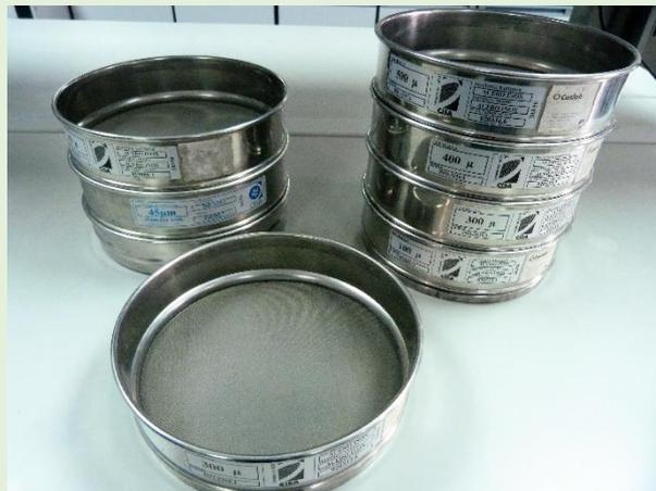
Figura 1. Vibroastidor y serie de tamices.
