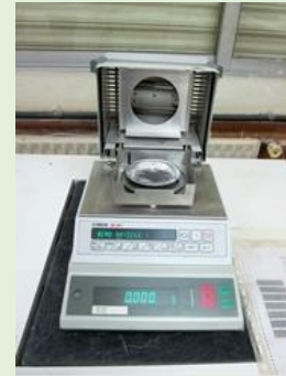
Figura 1. Termobalanza. Fotografía: Ana Monferrer. .
