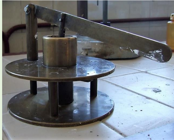
Figura 3. Molde para plasticímetro de Pfefferkorn. Fotografía: Maite Larena.
