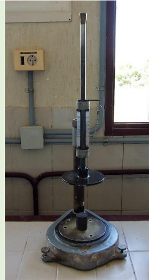
Figura 2. Plasticímetro de Pfefferkorn. Fotografía: Maite Larena.
