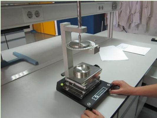
Figura 3. Nivelación del viscosímetro Gallenkamp
