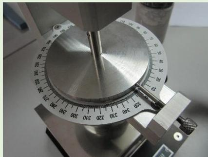
Figura 6. Bloqueo de la plataforma graduada.
