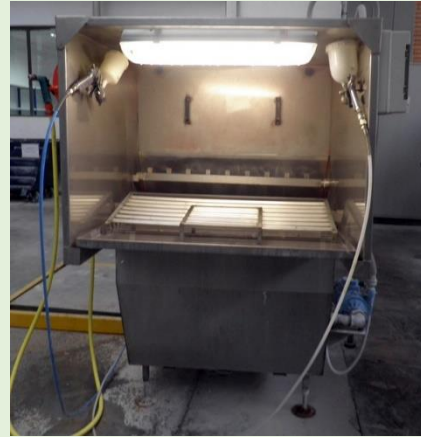
Figura 7 Cabina de esmaltado para laboratorio. Fotografía: Miquel Cantavella.
