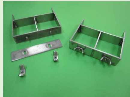
Figura 1 Patín de esmaltado con ranura regulable. Fotografía Ana Monferrer.
