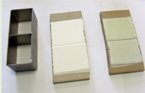
Figura 4 Pruebas de esmalte, preparadas con patín de esmaltado.
