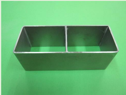
Figura 2 Patines de esmaltado con ranuras fijas. Fotografía: Ana Monferrer.
