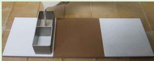
Figura 3 Preparación del esmaltado de probetas mediante patín. Fotografía: Ana Monferrer.
