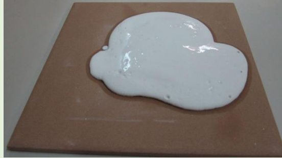
Figura 1. Vertido de la barbotina del vidriado sobre un soporte poroso. Fotografía: Ana Monferrer.
