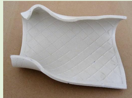
Figura 1. Deformación pirolástica. Fotografía: Ana Monferrer.
