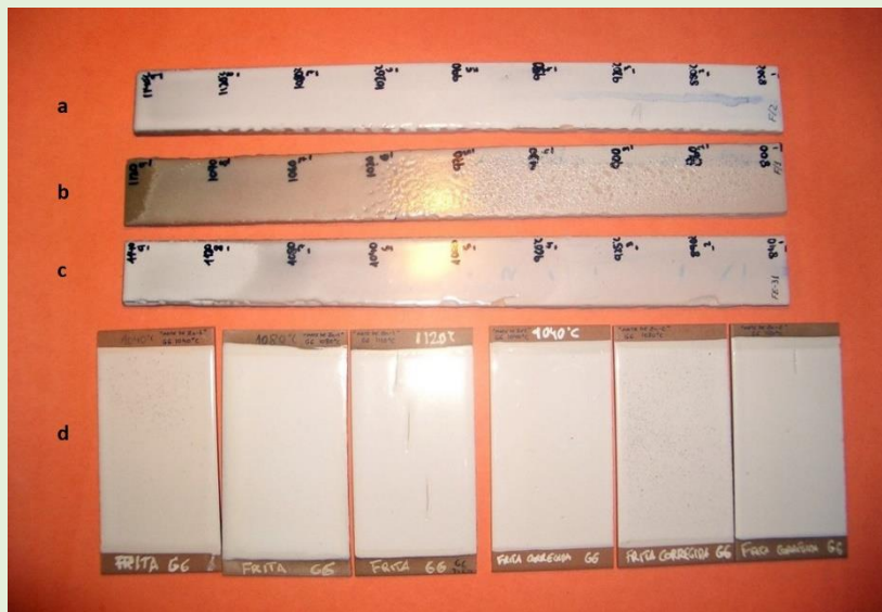
Figura 1 Probetas esmaltadas para la determinación del rango de cocción y de la temperatura de sellado.
