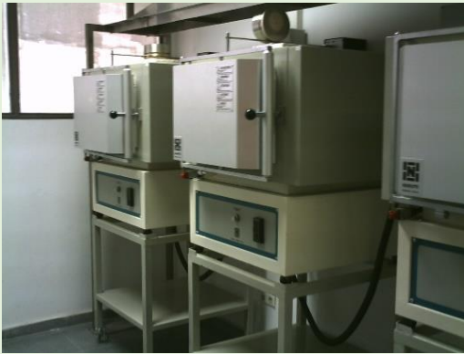
Figura 3 Hornos rápidos de laboratorio. Fotografía: Rafa Galindo.
