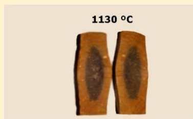
Figura 1. Probetas con corazón negro en una pasta de gres para pavimento.
