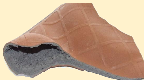
Figura 3. Baldosa deformada, con corazón negro. Fotografía: Rafa Galindo.
