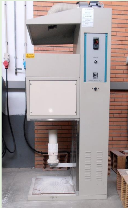
Figura 3. Horno de fusión de fritas con descarga manual. Fotografía: Miquel Cantavella (1).
