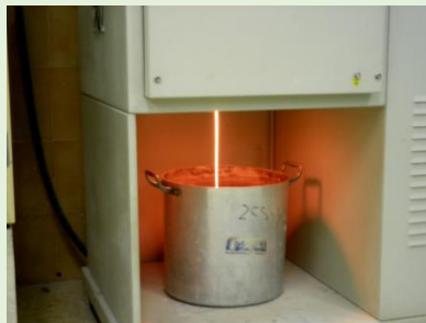
Figura 5. Descarga y enfriamiento de la frita fundida. Fotografía: Miquel Cantavella (1).
