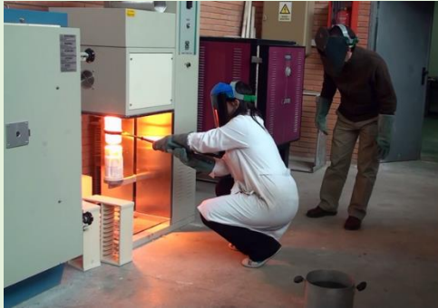
Figura 6. Descarga manual de la frita fundida. Fotografía: Miquel Cantavella (1) .
