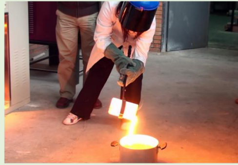
Figura 7. Enfriamiento de la frita fundida. Fotografía: Miquel Cantavella (1) .
