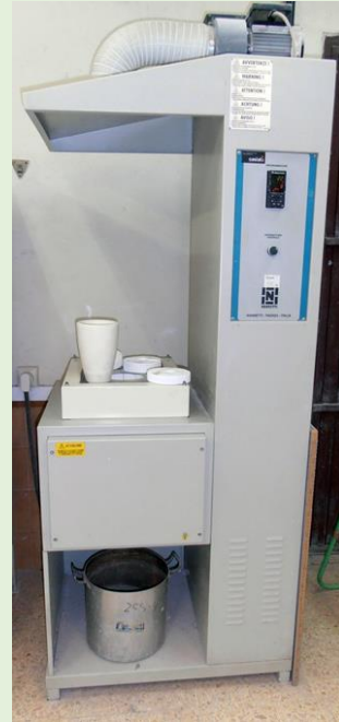
Figura 4. Horno de fusión de fritas con descarga automática. Fotografía: Miquel Cantavella (1).
