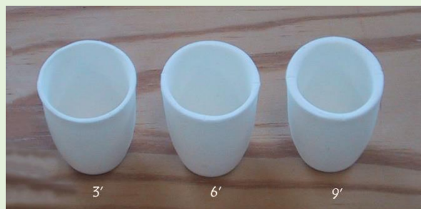
Figura 5. Probetas obtenidas a diferentes tiempos de colado. Fotografía: Maite Larena.
