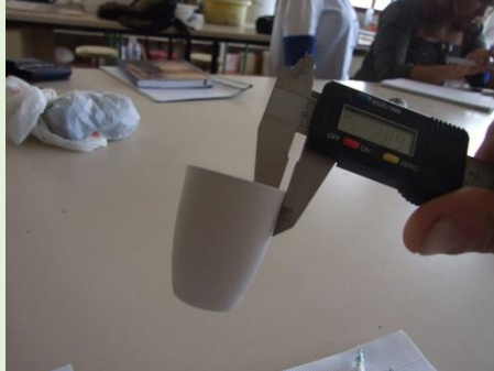
Figura 6. Medida del espesor de cada una de las probetas. Fotografía: Maite Larena.
