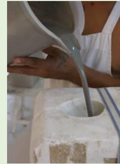
Figura 3. Llenado del molde.
