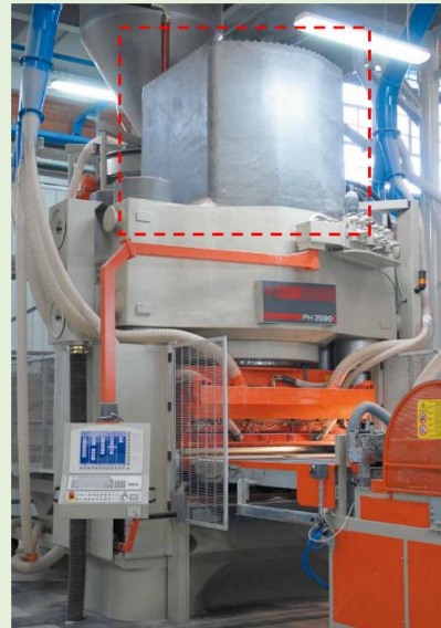
Figura 1. Depósito de aceite (recuadro) de una PH 3590 de SACMI.
