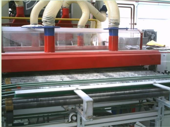
Figura 2. Tomas de aspiración en los cepillos de la rodillera a la salida de la prensa.
