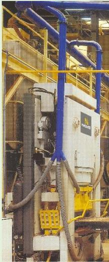
Figura 1. Tomas de aspiración de una prensa NASSETTI.
