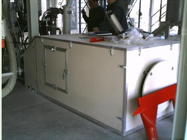
Figura 3. Instalación de insonorización de la central hidráulica de una prensa.
