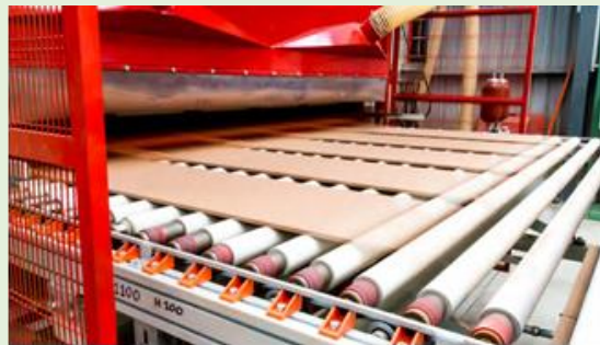
Figura 2. Protecciones delanteras laterales de una prensa SITI.
