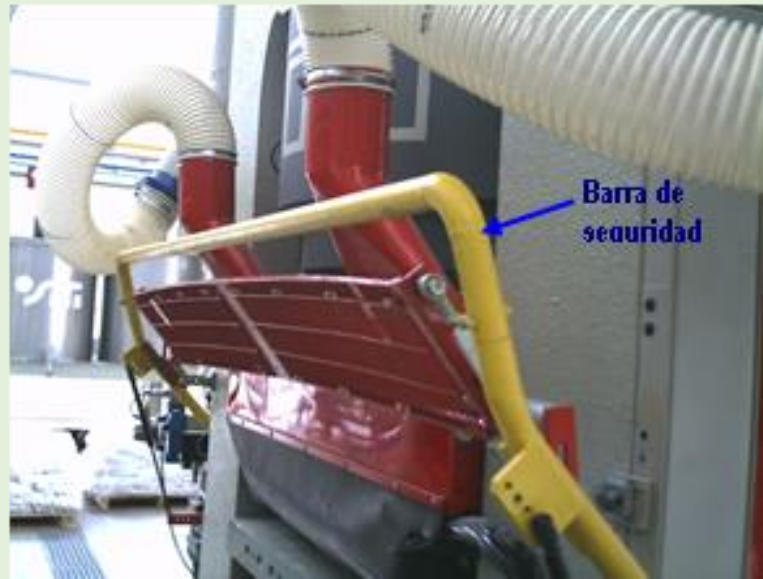
Figura 1. Barra de seguridad con rejilla de protección incorporada.
