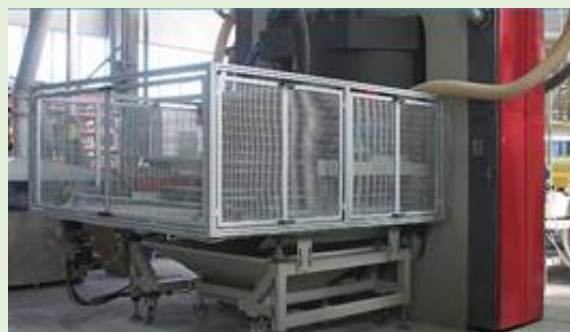
Figura 4. Protección mecánica fija del carro de alimentación en una prensa SITI & BT de alto tonelaje.
