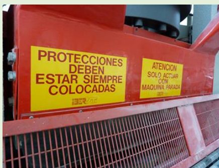
Figura 3. Protección mecánica vinculada con la barra de seguridad en una prensa SITI & BT de bajo tonelaje.
