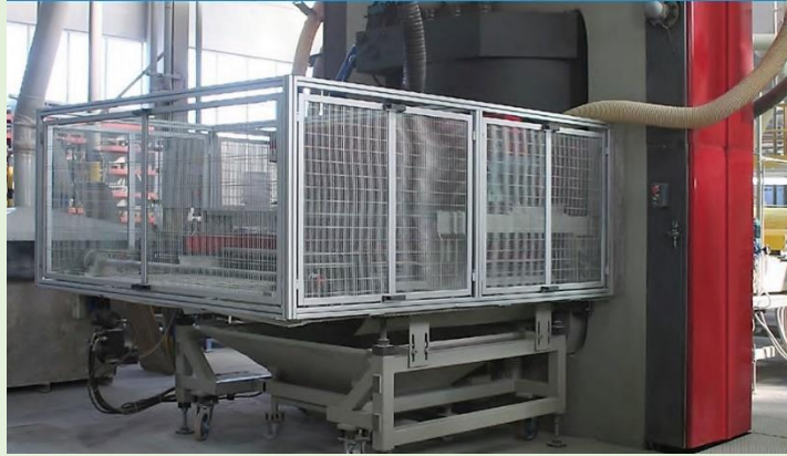
Figura 6. Carro de alimentación con sistema de rejillas flotantes y tolva fija instalado en una prensa SITI B&T.
