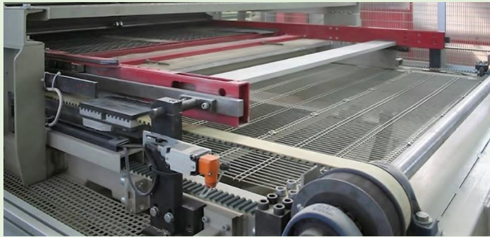
Figura 7. Carro de alimentación con sistema de rejillas flotantes y tolva fija instalado en una prensa SITI B&T.
