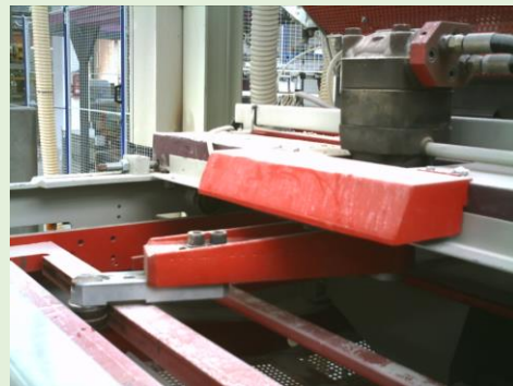
Figura 2. Sistema de tracción biela – manivela con motor hidráulico. Fotografía: Rafa Galindo.
