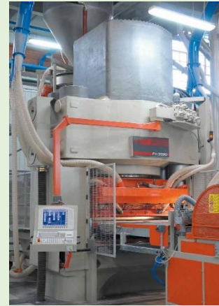
Figura 4. Prensa PH 2590 de SACMI con estructura en columnas. Imagen: SACMI.
