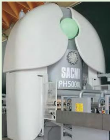
Figura 10. Prensa PH 5000L de SACMI con estructura en anillo cerrado. Imagen: SACMI.
