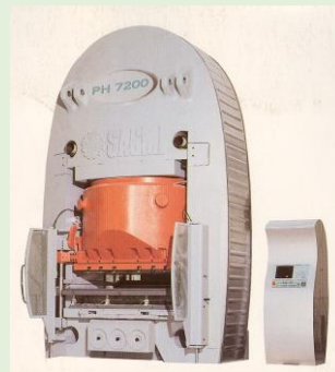
Figura 3. Prensa PH 7200 de SACMI con estructura en anillo cerrado. Imagen: SACMI.
