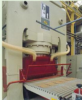
Figura 2. Prensa VIS 1000 de BARBIERI&TAROZZI con estructura en láminas. Imagen: BARBIERI-TAROZZI.
