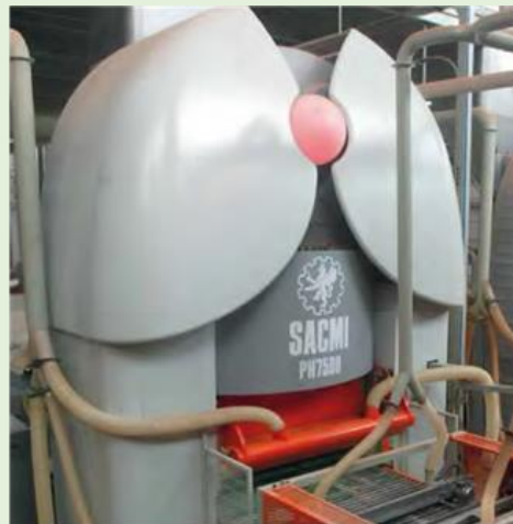
Figura 11. Prensa PH 7500 de SACMI con estructura en anillo cerrado. Imagen: SACMI.
