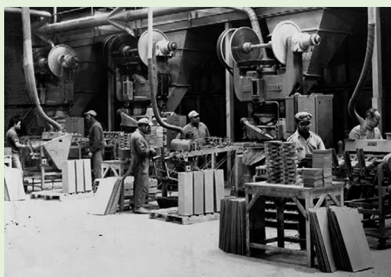
Figura 4. Sección de prensado (años 60 y 70) con prensas de fricción automáticas. Fotografía: Museo del Azulejo "Manolo Safont". Onda.
