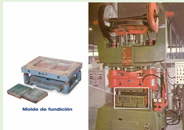
Figura 2. Prensa de fricción automática PE 500V de SACMI equipada con un molde de fundición.
