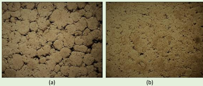
Figura 5 Deformación de gránulos de gres porcelánico sometidos a una presión de (a) 25 Kg/cm 2 y (b) 100 Kg/cm 2 .
